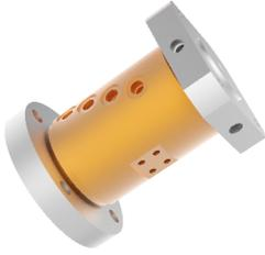
MQ400W 气/液旋转接头, 气滑环, 液压滑环, 自带转子双法兰, 可轴向承重100公斤, 可配M5、G1/8、G1/4、G3/8、G1/2大小接头, 可定制更大的接头比如G1", G2", 能通过的介质有: 压缩空气、真空、氢气、氮气、化学混合气体、蒸汽、冷却水、热水、热油、石油、硫酸、饮料等。
