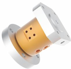
MQ200W 气/液旋转接头, 气滑环, 液压滑环, 自带转子双法兰, 可轴向承重100公斤, 可配M5、G1/8、G1/4、G3/8、G1/2大小接头, 可定制更大的接头比如G1", G2", 能通过的介质有: 压缩空气、真空、氢气、氮气、化学混合气体、蒸汽、冷却水、热水、热油、石油、硫酸、饮料等。
