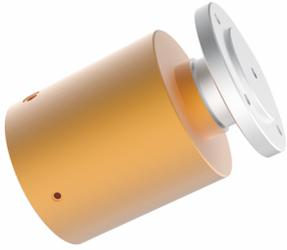
MQ104 气/液旋转接头, 气滑环, 液压滑环, 可配M5、G1/8、G1/4、G3/8、G1/2大小接头, 可定制更大的接头比如G1", G2", 能通过的介质有: 压缩空气、真空、氢气、氮气、化学混合气体、蒸汽、冷却水、热水、热油、石油、硫酸、饮料等。
