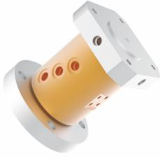
MQ300W 气/液旋转接头, 气滑环, 液压滑环, 自带转子双法兰, 可轴向承重100公斤, 可配M5、G1/8、G1/4、G3/8、G1/2大小接头, 可定制更大的接头比如G1", G2", 能通过的介质有: 压缩空气、真空、氢气、氮气、化学混合气体、蒸汽、冷却水、热水、热油、石油、硫酸、饮料等。
