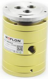
MQ300 气/液旋转接头, 气滑环, 液滑环, 可配M5、G1/8、G1/4、G3/8、G1/2大小接头, 可定制更大的接头比如G1", G2", 能通过的介质有: 压缩空气、真空、氢气、氮气、化学混合气体、蒸汽、冷却水、热水、热油、石油、硫酸、饮料等。
