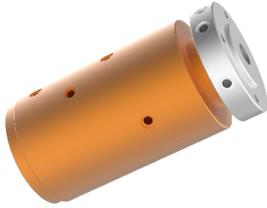
MQ600F 气/液旋转接头, 气滑环, 液压滑环, 可配M5、G1/8、G1/4、G3/8、G1/2大小接头, 可定制更大的接头比如G1", G2", 能通过的介质有: 压缩空气、真空、氢气、氮气、化学混合气体、蒸汽、冷却水、热水、热油、石油、硫酸、饮料等。
